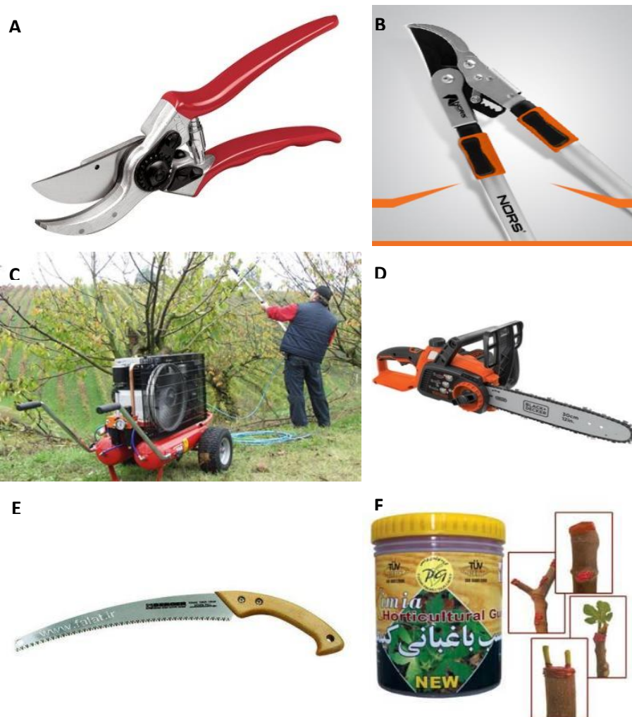
شکل ۲۵: ادوات لازم برای هرس شامل: قیچی باغبانی (A)، قیچی شاخه زن (B)، قیچی موتوری پنوماتیک (C)، اره موتوری (D)، اره معمولی (E) و چسب پیوند (F).
